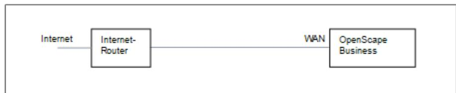
Dazu nutzen Sie den WAN-Anschluss des Kommunikationssystems. OpenScape Business kennt entweder den Internet-Router oder arbeitet als DHCP-Client. Diese Möglichkeit kann verwendet werden, wenn der Internet-Router
