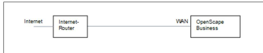
Dazu nutzen Sie den WAN-Anschluss des Kommunikationssystems. OpenScape Business kennt entweder den Internet-Router oder arbeitet als DHCP-Client. Diese Möglichkeit kann verwendet werden, wenn der Internet-Router in einem anderen Netzsegment liegt und einen eigenen DHCP-Server hat.
